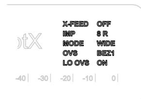
**X-FEED** Zeigt an, ob die Cross-Feed-Funktion ein- (ON) oder ausgeschaltet (OFF) ist.
